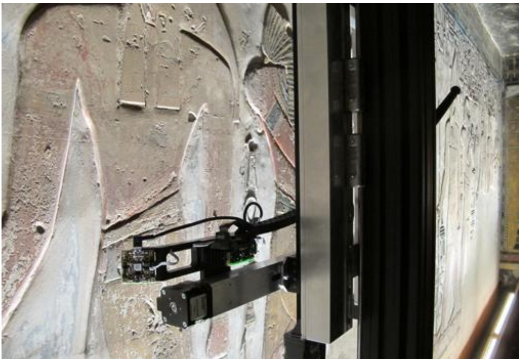
El escáner Lucida tomando datos de la tumba de Seti en Egipto-FACTUM ARTE
