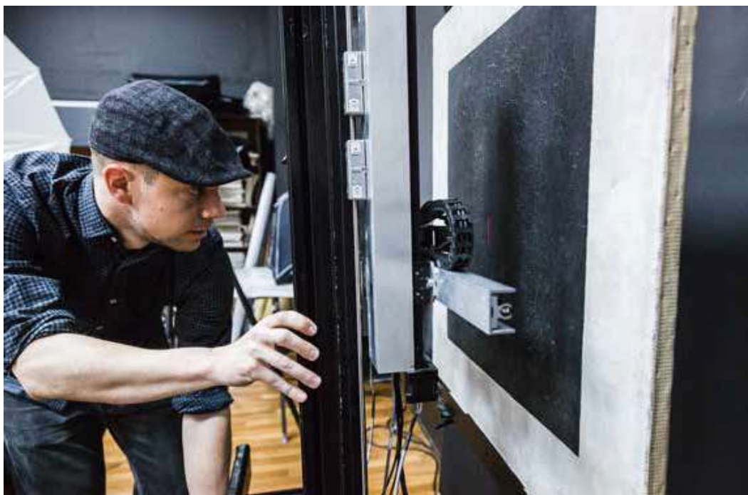
Carlos Bayod Lucini usando el escáner 3D Lucida para la digitalización de la superficie del Black Square de Malevich, 1915 en la Tretyakov Gallery, Moscova © Tretyakov Gallery
