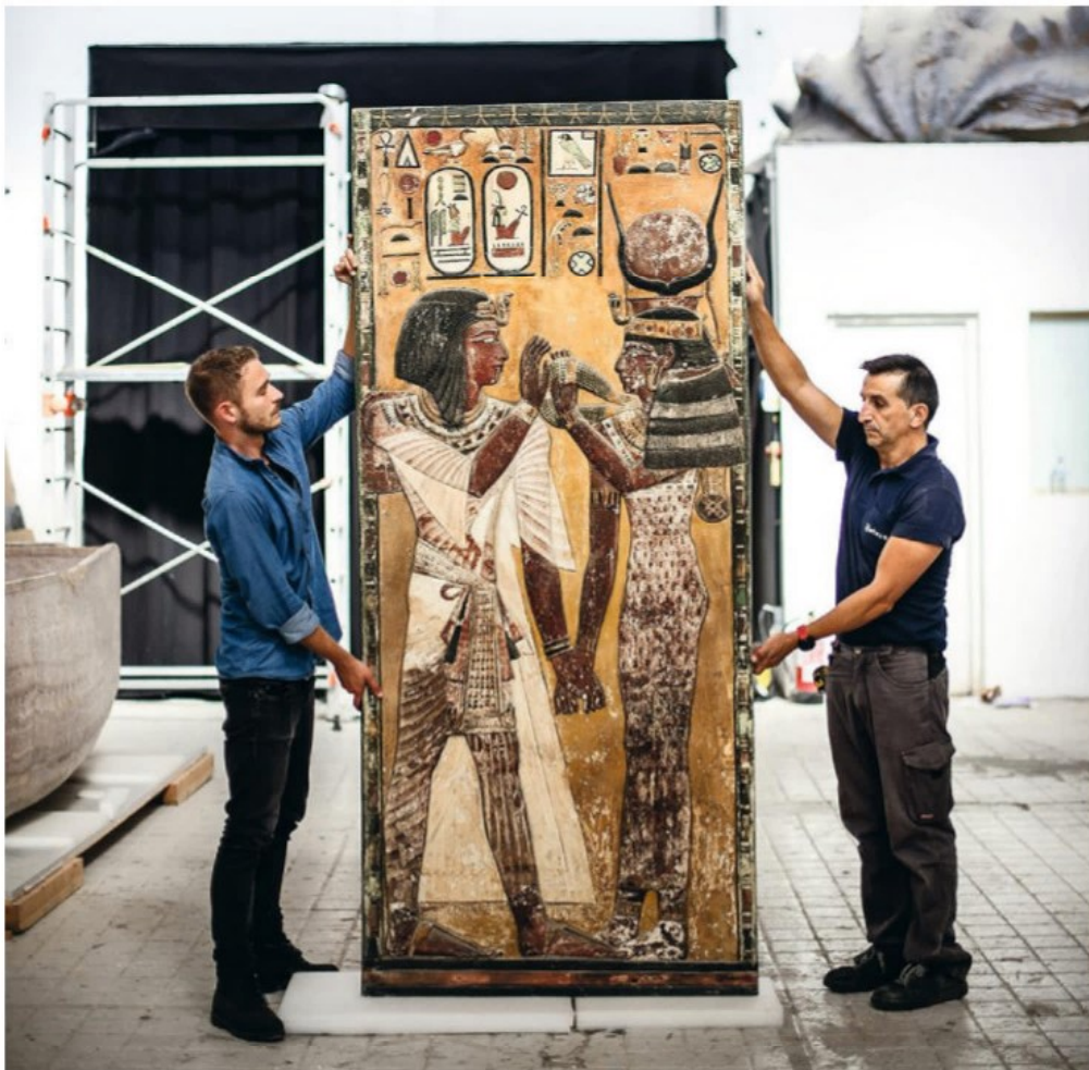
Dans les ateliers madrilènes de Factum Arte, un pan de mur du tombeau du pharaon Sethi I er . Après le scanner des parois, les données de couleur ont été imprimées sur des « peaux », elles-mêmes appliquées sur des plaques de polyuréthane fraisées.
