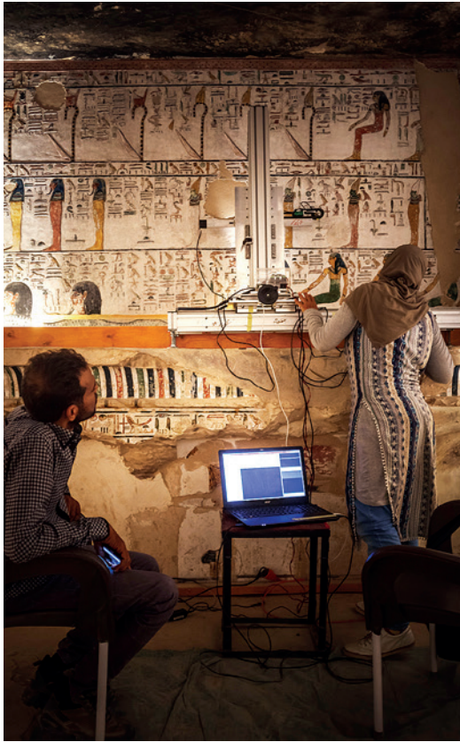
3. Stagiaires de la Theban Necropolis Preservation Initiative utilisant le scanner 3D Lucida pour numériser la surface du mur sud de la salle Ja à l'intérieur du tombeau de Séthi I er , Louxor, 2019.
