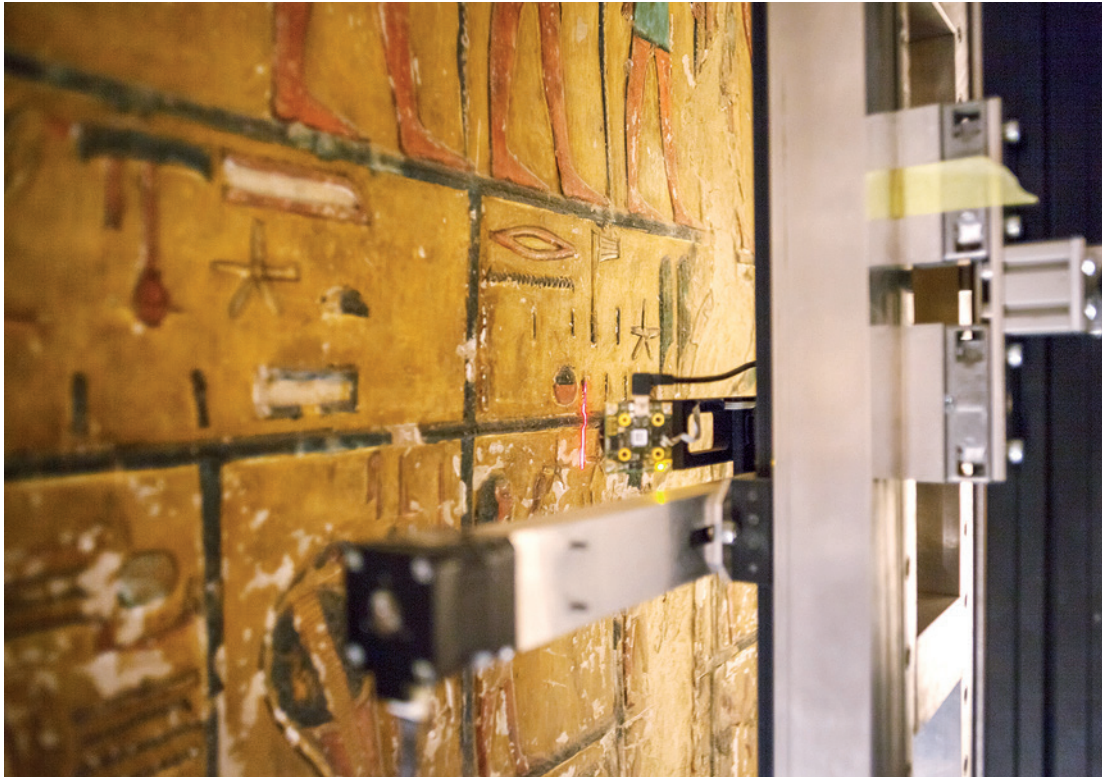
4. Détail du scanner 3D Lucida numérisant la surface du mur oriental de la salle J à l'intérieur du tombeau de Séthi I er , Louxor, 2019.
