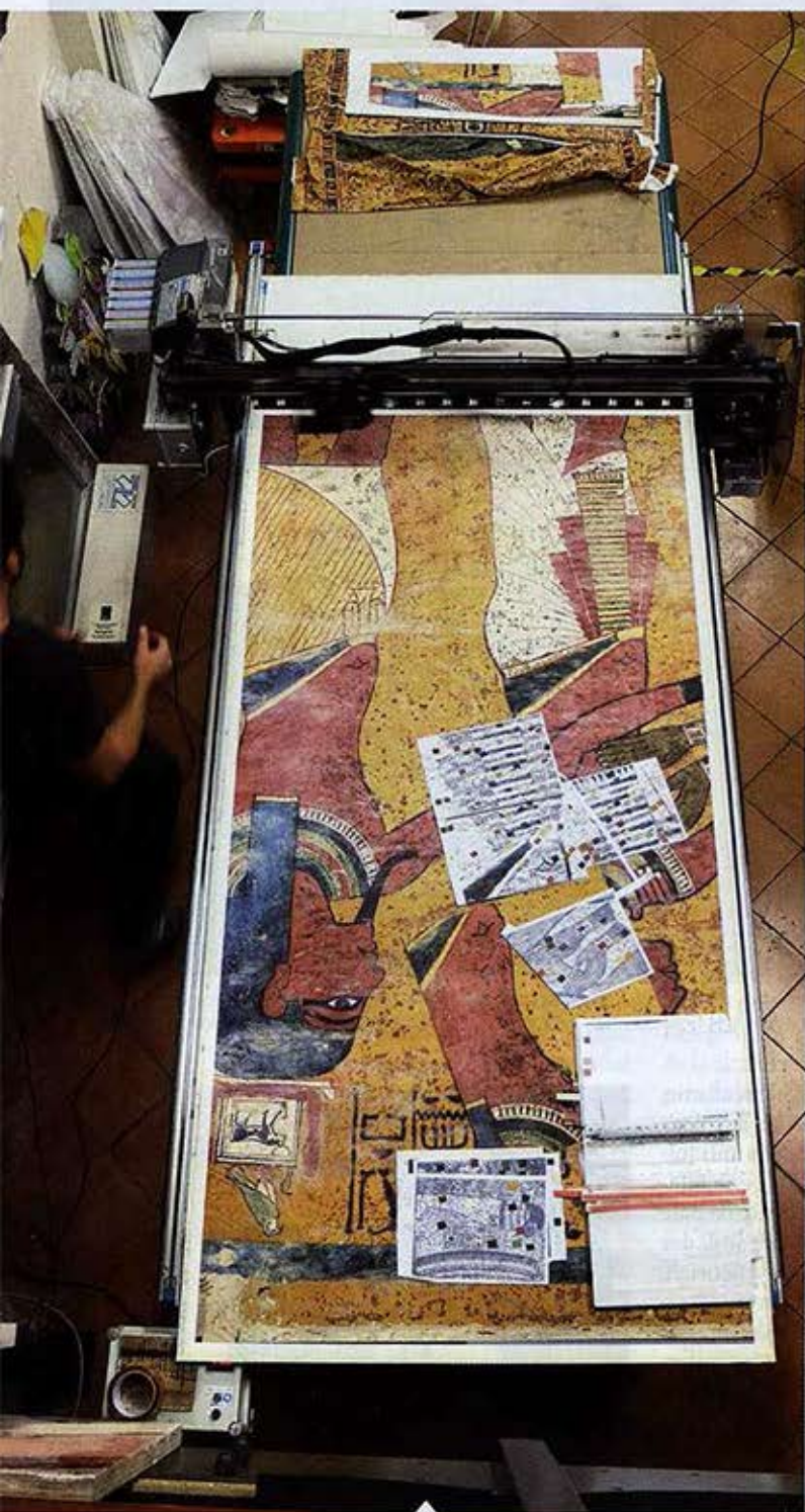
Tests de colorimétrie sur un panneau reproduit par l'imprimante numérique à jet d'encre à plat. La couleur et la tonalité peuvent être contrôlées et modifiées localement pour assurer une restitution parfaite.
